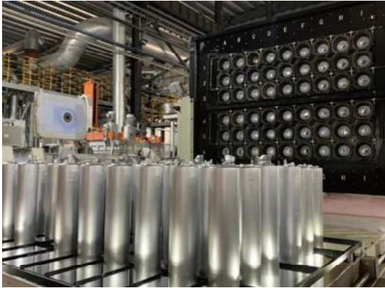
图4 热顶 DC 铸造生产的手机壳体用铝合金铸锭及铸锭横截面高倍组织
