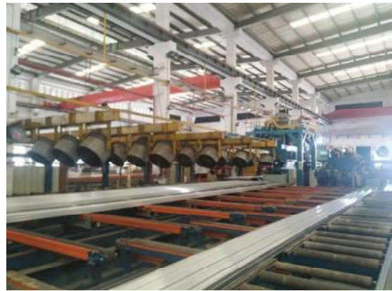
图5 铝合金挤压在线水冷和在线风冷
