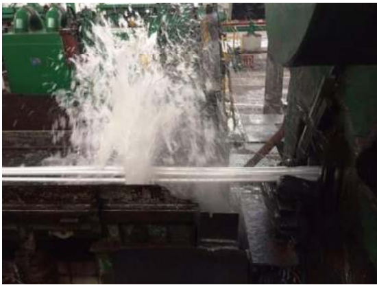
图5 铝合金挤压在线水冷和在线风冷
